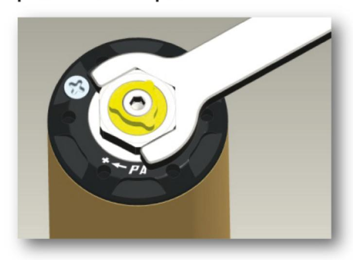
Il precarico della molla è fondamentale ai fini del funzionamento delle sospensioni.
